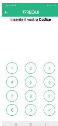
Se il codice è autorizzato, la manopola si illuminerà di verde e il menu principale per il funzionamento della cassaforte apparirà nell'applicazione mobile. In caso contrario, la manopola si illuminerà di rosso e l'applicazione visualizzerà un messaggio di errore.
