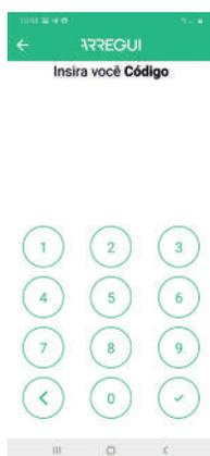
Se o código estiver autorizado, o puxador ilumina-se de cor verde e aparece na aplicação móvel o menu principal para poder operar com o cofre. Caso contrário, o puxador ilumina-se de cor vermelha e na aplicação aparecerá uma mensagem de erro.
